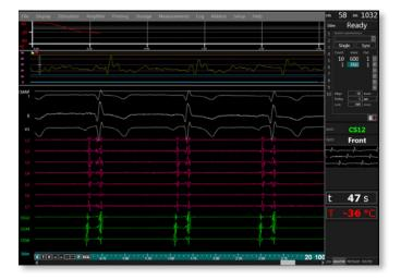
Spezielle Anzeige-Modi, wie der Trigger- und der Druck-Modus und mehrere vom Benutzer konfigurierbare Split-Screen-Modi bieten die perfekte Vorrausetzung, um verschiedene Signalarten anzuzeigen. So können z. B. alle Oberflächen- und intrakardiale EKG-Signale, invasiver Blutdruck und Ablationsdaten (HF- und Kryo-Ablatoren werden unterstützt) in dem für Sie maßgeschneiderten Layout angezeigt werden.
